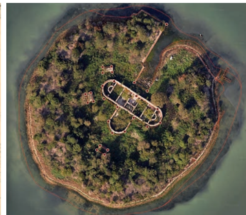
10 | Visualizzazione su nuvola di punti in pianta del posizionamento dei punti GPS rilevati e dei ground control point (GCP) utilizzati in fase di georeferenziazione. Schema del processo di georeferenziazione di una delle fasi trasformative dell'isola di San Secondo all'interno del sistema informativo geografico.
