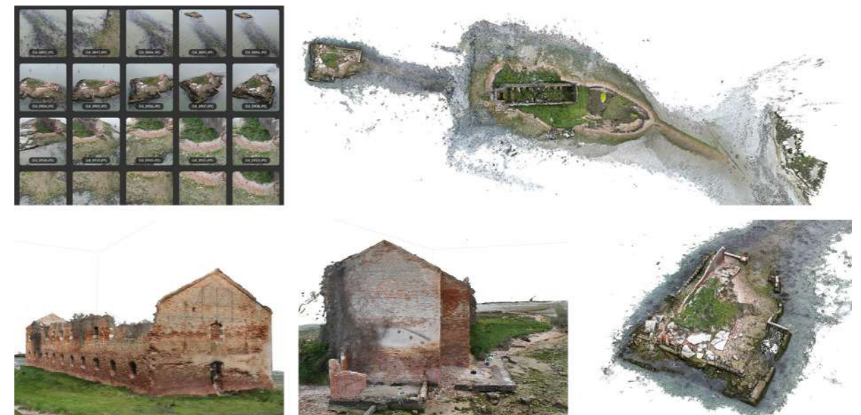
Fig. 7 - Ricostruzioni fotogrammetriche dell'isola di Madonna del Monte. Viste delle nuvole in prospettiva e assonometria.
